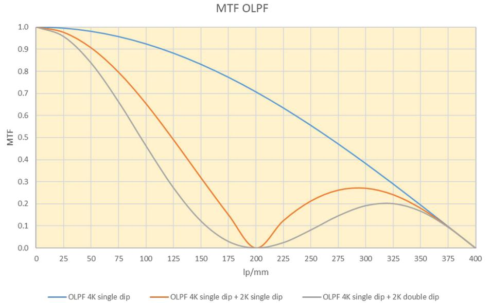
**Figura 7** – Comparação da MTF dos diferentes filtros ópticos passa-baixa.
